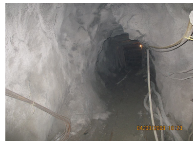
图 2 普通爆破巷道形状
